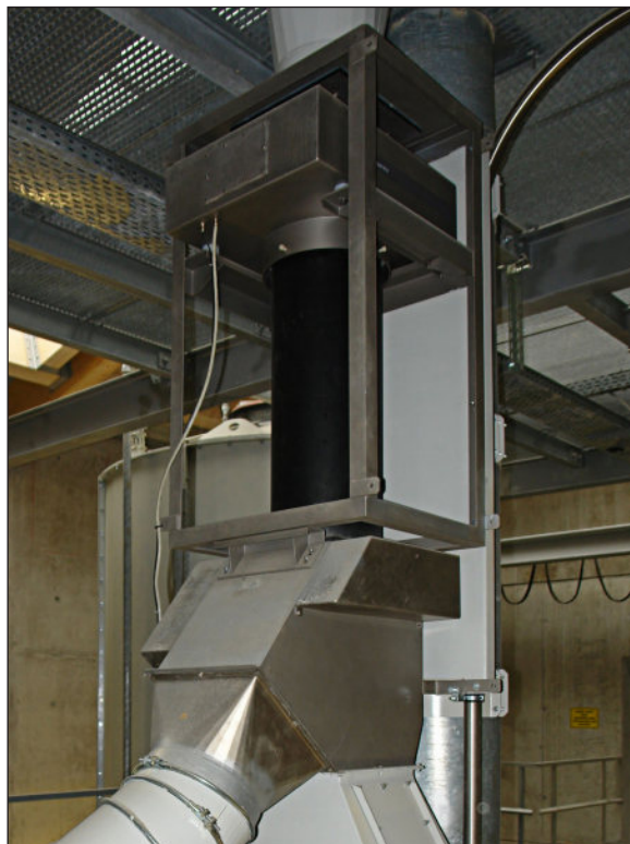
Exemple: Séparateur de métaux RAPID DUAL en protection de machine lors de la fabrication de pellets. (ancienne version)
