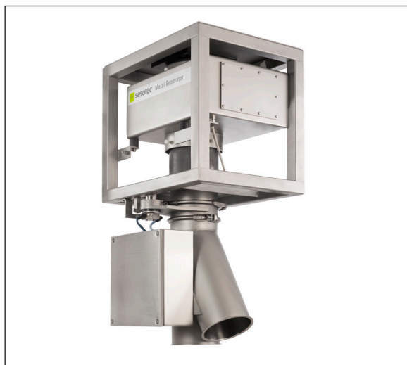
Détecteur de métaux P-SCAN RG intégré dans le séparateur de métaux RAPID 5000 pour analyser des produits en vrac en chute gravitaire.
