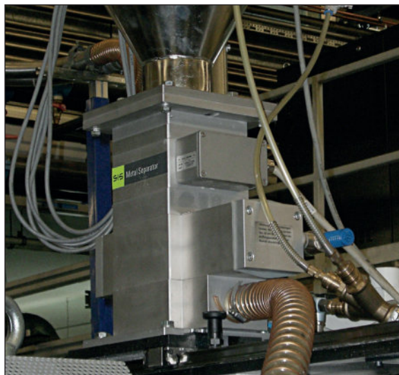
Exemple: Séparateur de métaux PROTECTOR intégré à l'entrée matériau d'une extrudeuse (ancienne version)
