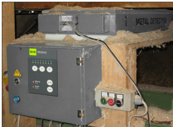
Exemple: Détecteur de métaux plat ELS avec électronique PRIMUS pour analyser des déchets de bois. (ancienne version)
